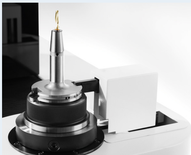
Posicionamiento automático de la cabeza de lectura/escritura Posicionamento automático da leitura/escritura
