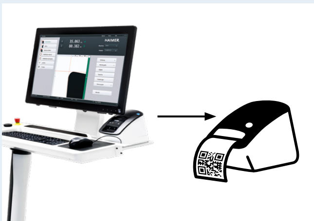
Después de la medición de la herramienta, una etiqueta con el código QR se imprime Após medir a ferramenta, uma etiqueta com o código QR é impressa
