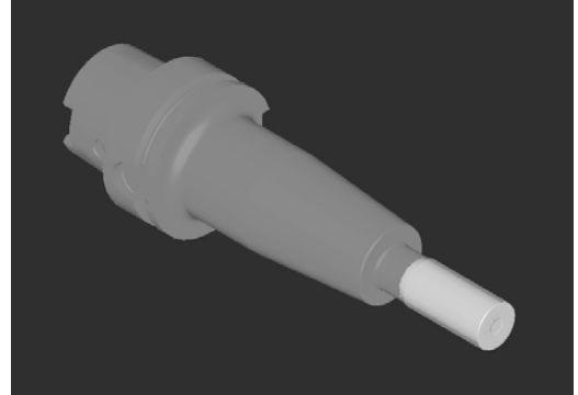
Modelo 3D con diferenciación visual simple corte/no corte Modelo 3D com diferenciação visual simples corte/sem corte
