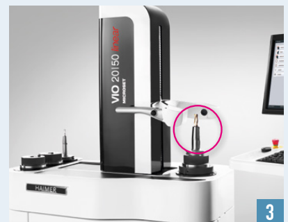
1 Segunda cámara para determinar el centro de giro (opcional)/Segunda câmara para determinar o centro de giro (opcional)
