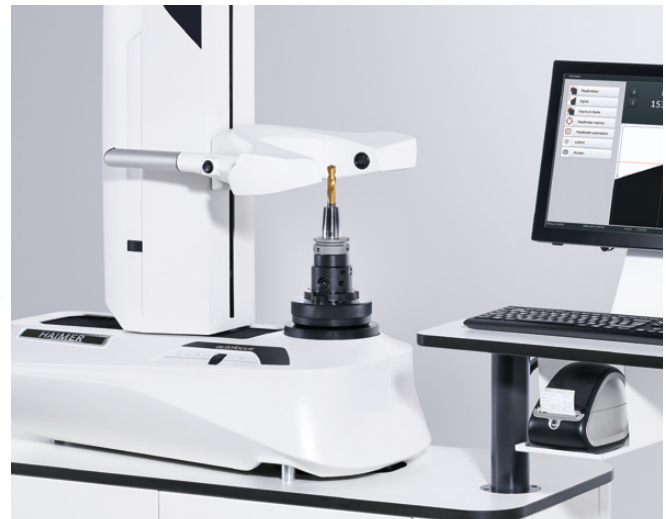
Automatisches Scharfstellen der Schneide Automatic focus on the cutting edge
