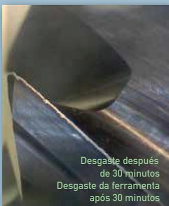
Desgaste uniforme de los cuatro filos de la herramienta
