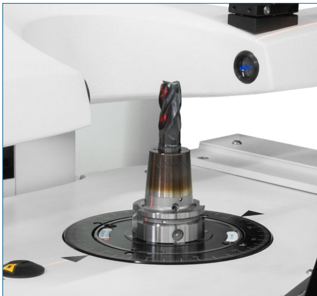
Бесконтактное измерение с помощью камеры высокого разрешения и цифровой обработки изображений, вкл. измерительное программное обеспечение „Microvision“
